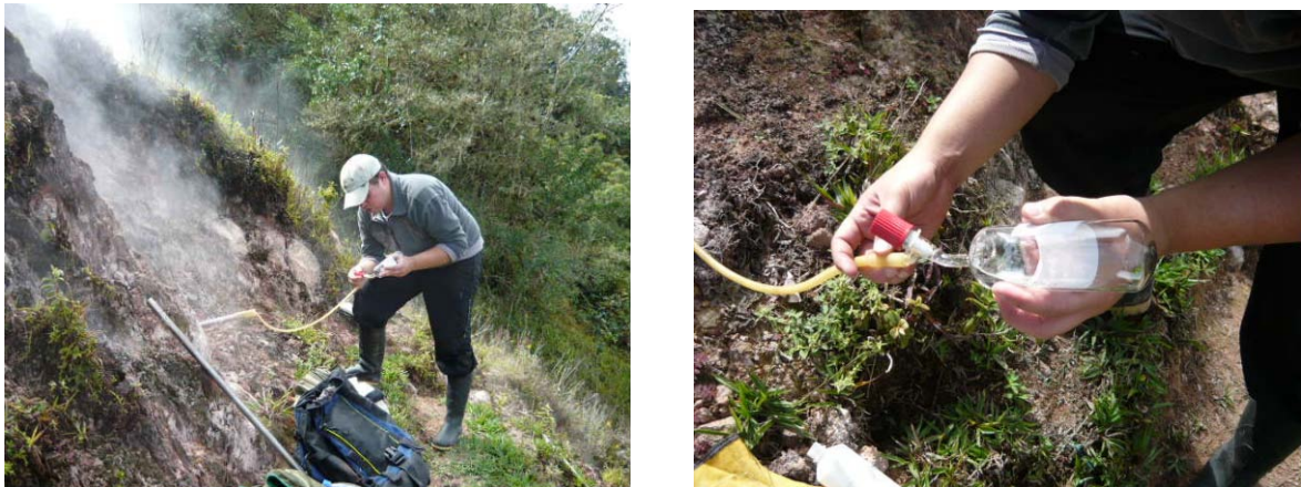
Figura 95. Modo de muestreo Directo con Botellas de Giggenbach en la Fumarola La Macha. Volcán Cerro Machín.
