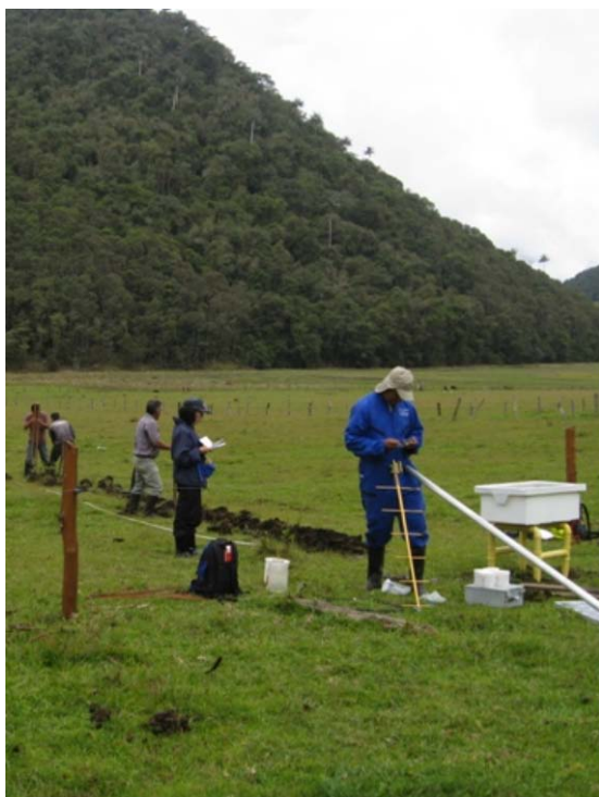
Figura 73. Adecuación para la instalación de los electrodos del magnetómetro de DOMO
