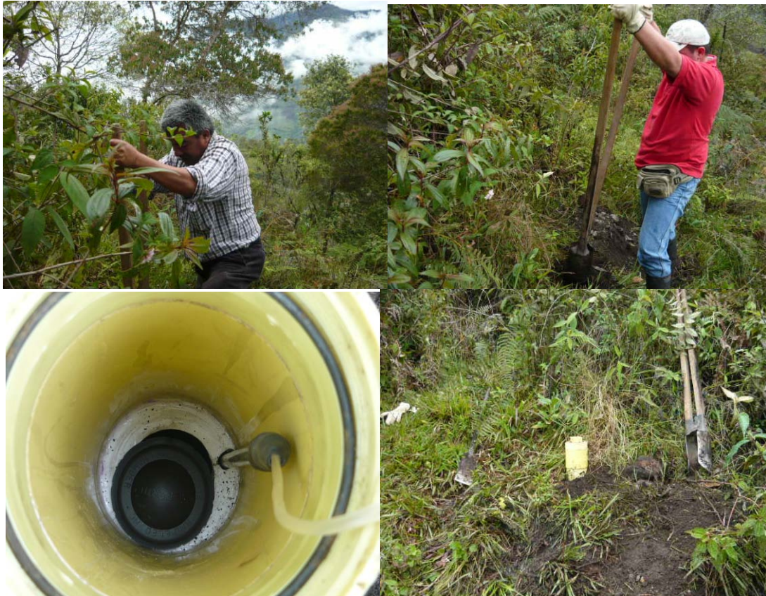
Figura 75. Modo de Instalación de Estaciones para el Monitoreo de Gas Radón en suelo. Volcán Cerro Machín.
