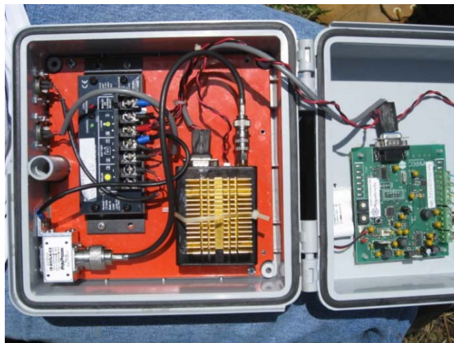
Figura 72. Sistema electrónico con disipador de calor instalado
