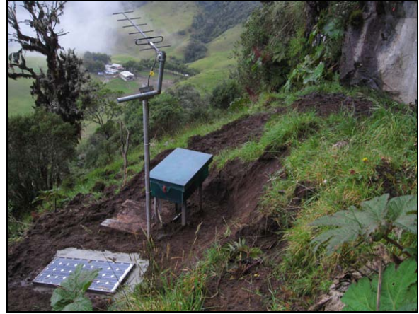
Figura 115. Instalaciones del nuevo sitio para la estación de corto periodo CAJONES
